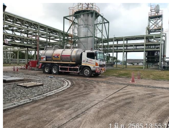
ภาพที่ 2-30 การสุบถ่ายแอมโมเนียมไฮดรอกไซด์เหลว
